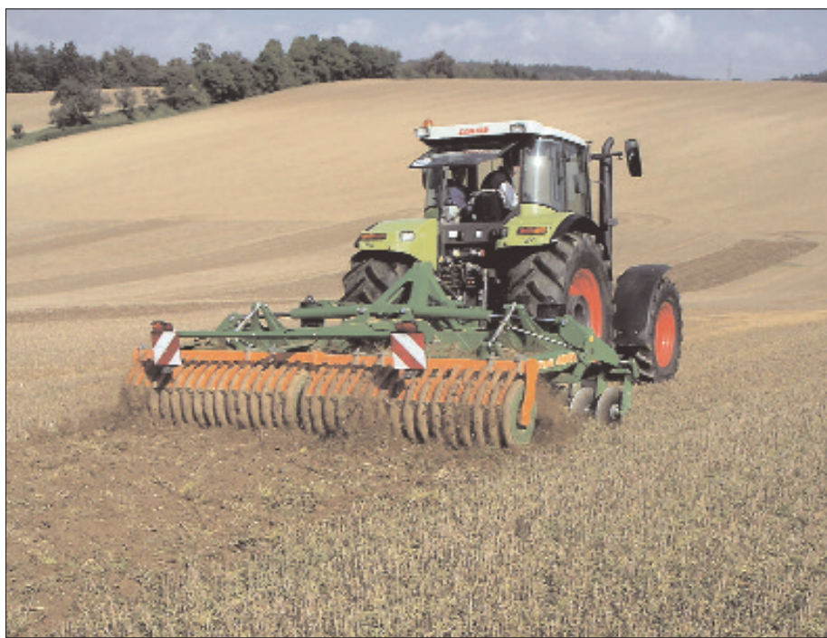
Kurzscheibenegge für eine flache Stoppelbearbeitung.
