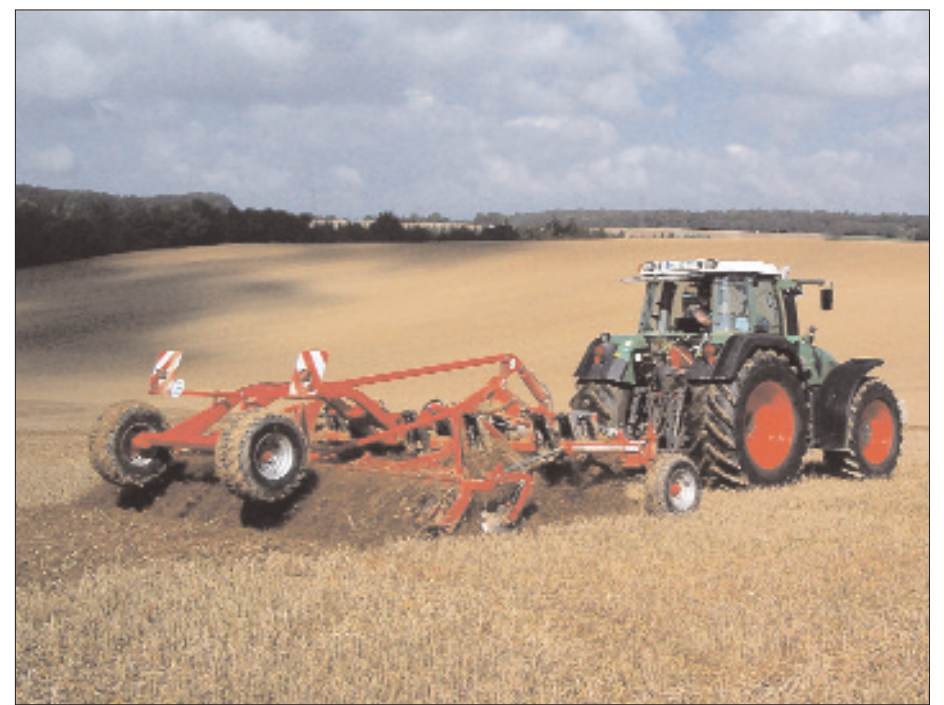
Mehrbalkiger Grubber für flache und tiefe Bearbeitung.
