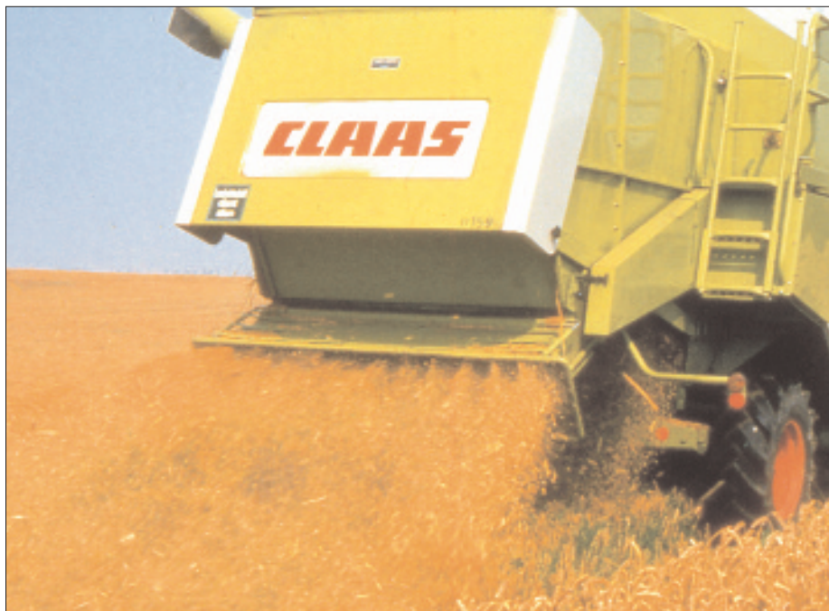
Exakte, gleichmäßige Verteilung des kurz gehäckselten Strohs über die gesamte Arbeitsbreite ist die Voraussetzung für ein gelungenes Strohmulch-Verfahren.
