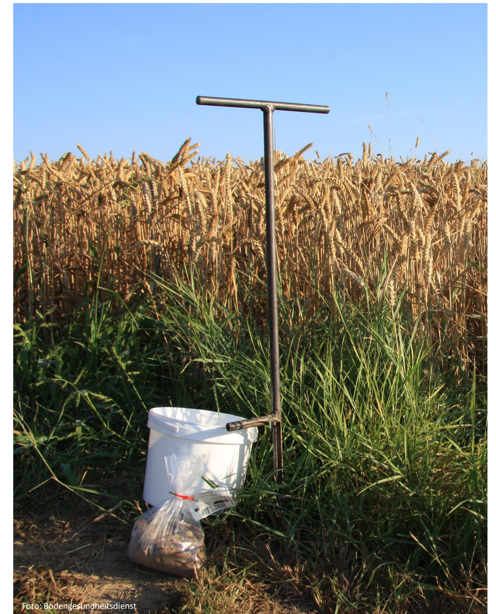
Ziehen der Bodenproben mit dem Bohrstock
